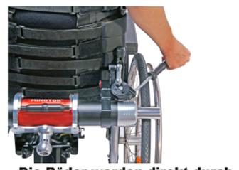
Die Räder werden direkt durch die Motorisierung angetrieben. Entkoppelung ist um im Leerlauf zu fahren möglich.
