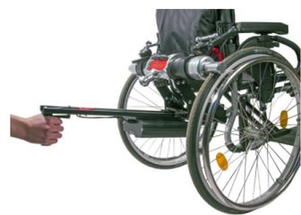
Schieben Sie die Batterie auf die Motorisierung. Die Verbindung wird automatisch hergestellt
