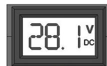
Die Lithiumbatterie ist vollgeladen, wenn am Display eine Spannung zwischen 28.0V und 28.2V angezeigt wird.
